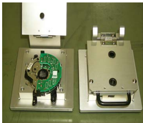
作業工程治具 ネジ締め
